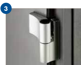
BÄNDER (3 STÜCK) *) Aufliegende zweiteilige Türbänder, dreidimensional verstellbar, in EV1, Tragkraft bis 160 kg Flügelgewicht pro Band
